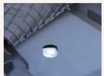
キャブフロアマット下に設けたウォッ シヤ液タンク。
