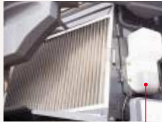
左サイド ラジエーターリザーバタンク
