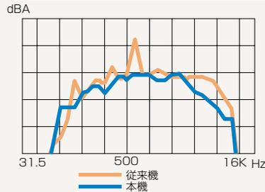
新採用の電子制御コモンレール式エンジンは独特の燃料噴射方式で低騒音。さらにポンプの改善などにより油圧リリーフ時の耳障りな音域をカットしています。
