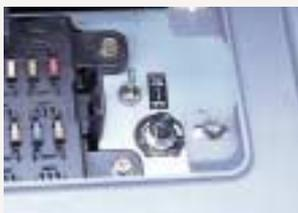
ITCSメカトロコントローラに不測のトラブルが生じて、非常アクセルにより運転の継続が可能。また、バックアップシステムにより自動で非常運転モードに切り替わります。
