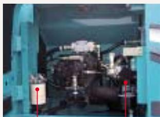
点検・整備対象へのアプローチのしやすさを追求。左サイドカバー内にエアクリーナ、バッテリー、並列クーリングユニットなどを、右サイドにリモート化したエンジンオイルフィルタ、ウォータセパレーター一体型燃料フィルタを配置しました。
